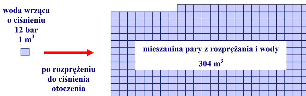
Rysunek 2. Przyrost objętości wody wrzącej pod wysokim ciśnieniem po rozprężeniu jej do ciśnienia otoczenia.
